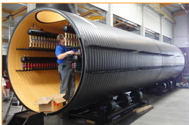
Der größte Verteilerschacht der Firma FRANK aus PE-Wickelrohr Quelle: FRANK GmbH
