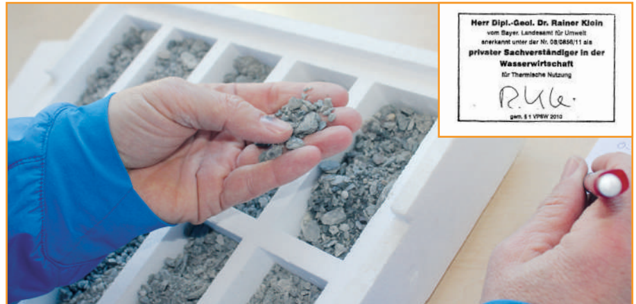
Der sachverständige Geologe bei der Bestimmung des Bohrprofils mittels Gesteinproben. Quelle: BauGrund Süd
