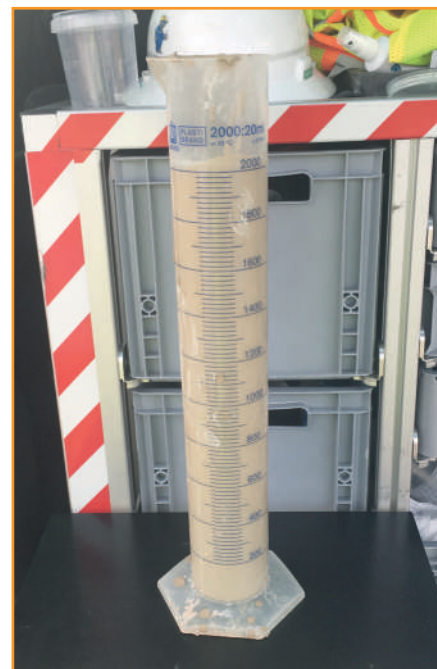
Ein weiterer Baustellentest ist das testen des Absetzverhaltens. Hier wird die Aufnahme des Wassers im Baustoff getestet. Als sehr gut kann man Werte <2% betrachten. Quelle: Fischer Spezialbaustoffe GmbH
