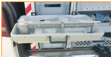
Die Spülungswaage zeigt im Ruhezustand die erreichte Dichte an. Quelle: Fischer Spezialbaustoffe GmbH
