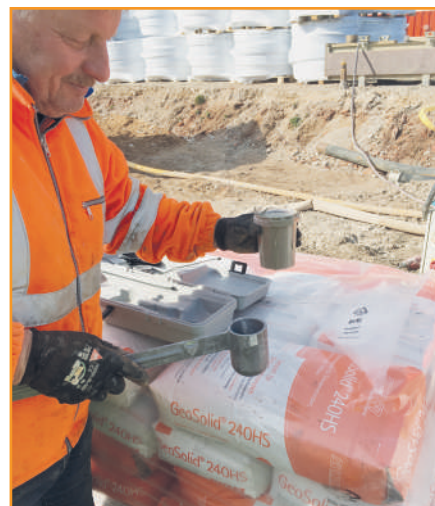
Reinhold König von der Bohrfirma Max Streicher überprüft die Dichte mit der Spülungswaage. Quelle: Fischer Spezialbaustoffe GmbH
