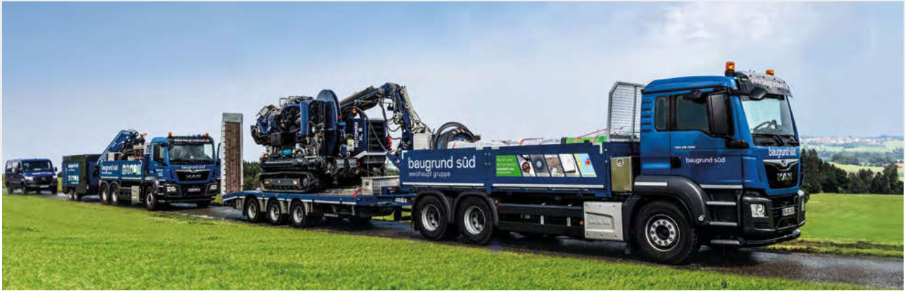
Die Bohrkolonne von BauGrund Süd mit Bohrgerät, Material-LKW inkl. Kompressor und einem Service-Fahrzeug.
