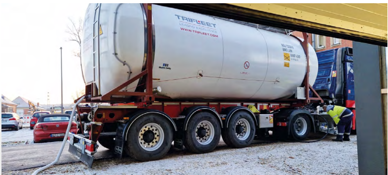
Anlieferung des gebrauchsfertigen Wärmeträgerkonzentrats im Tankwagen - umpumpen in die IBC-Container.
