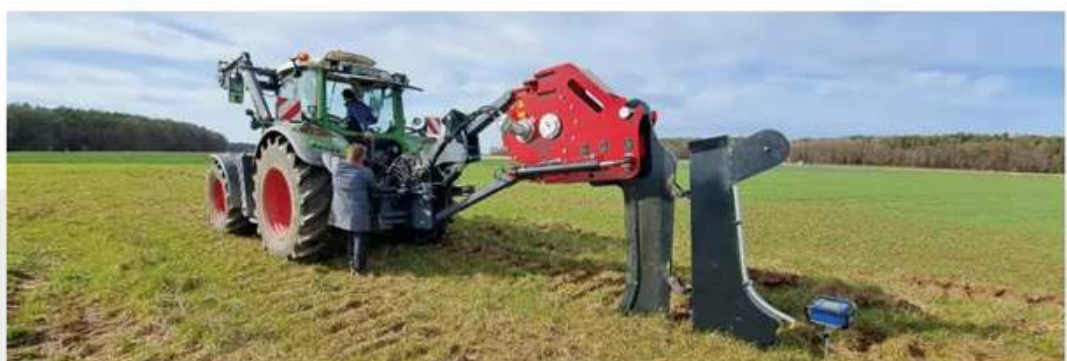
Abb. 4 Feldtest des Vibrations-Anbaupflugs. Foto: FAU
