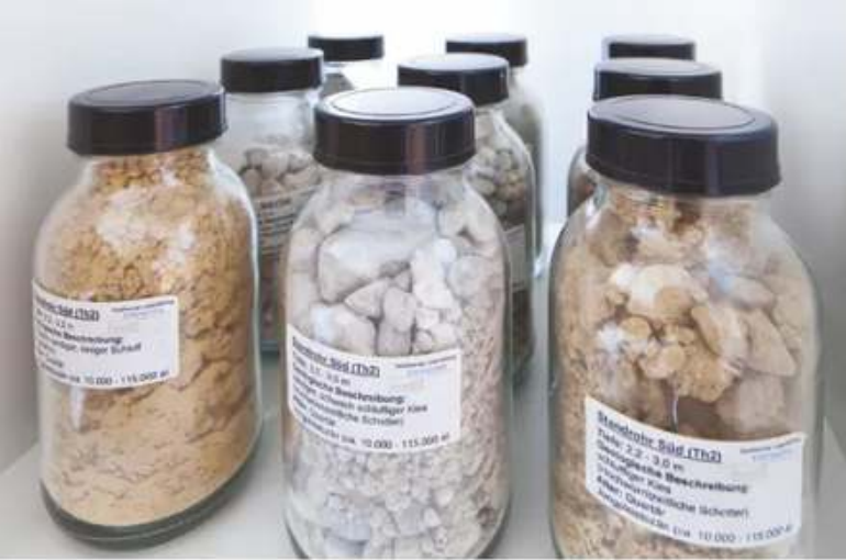
Abb. 2 Jungpleistozäne Lockerablagerungen in Probengefäßen. Abhängig von den Sedimenteigenschaften wird die oberflächennahe Geothermianlage ausgelegt.
