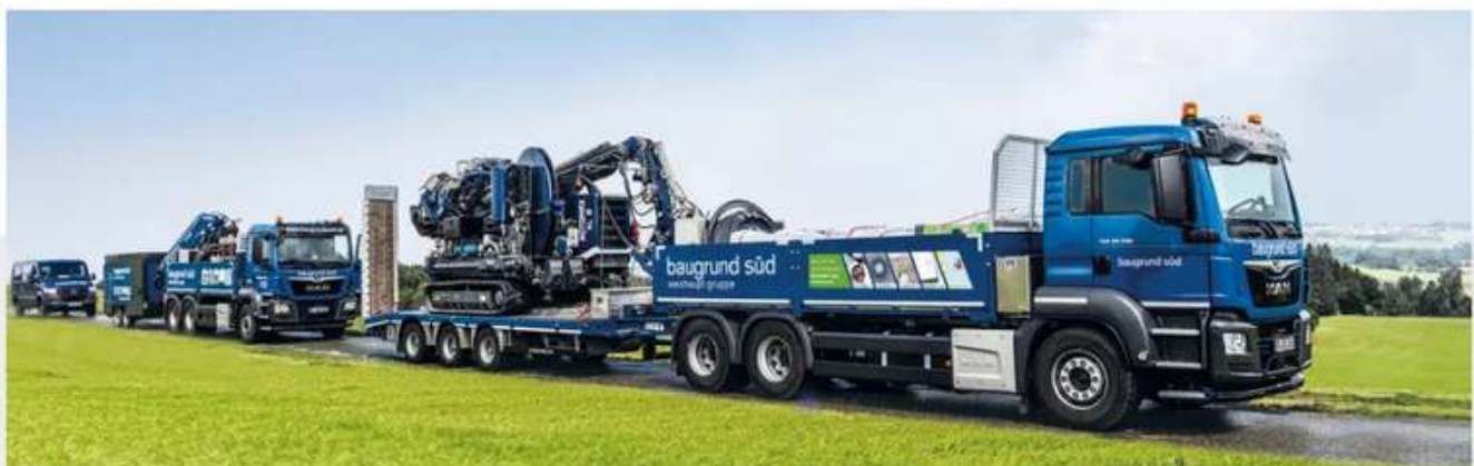
Abb. 1 Eine Bohrkolonne von BauGrund Süd mit Bohrgerät, Material-LKW inkl. Kompressor und einem Service-Fahrzeug.
