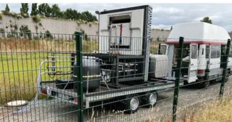
Abb. 2 Mobile Einheit des neu entwickelten ICE-TRT. Foto: FAU
