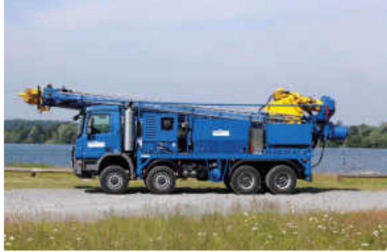
Abb. 6 DSB 5/50, bis Bohrtiefen von 1500m.
