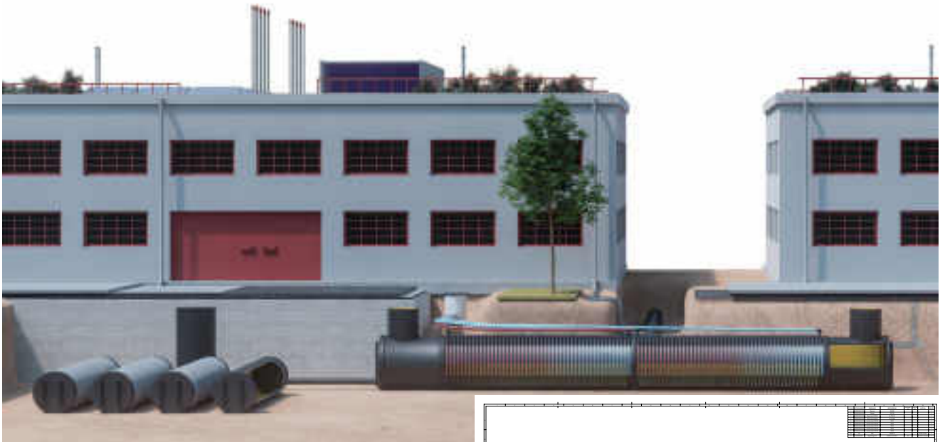
Abb. 8 Anordnung der Tanks im Zufahrtsbereich der Gebäude.
