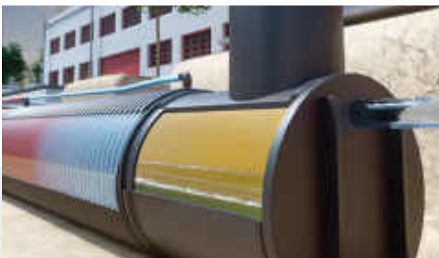
Abb. 10 Prinzipskizze des Tanks, im Inneren fließt das Oberflächenwasser und wird teilweise gespeichert, außen sind die Medienrohre für die Wärmeübertragung.
